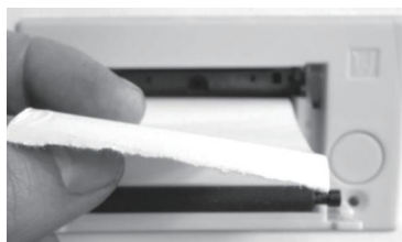
Obr. 6-11 Umístění zadního krytu z papíru na přední kryt.
